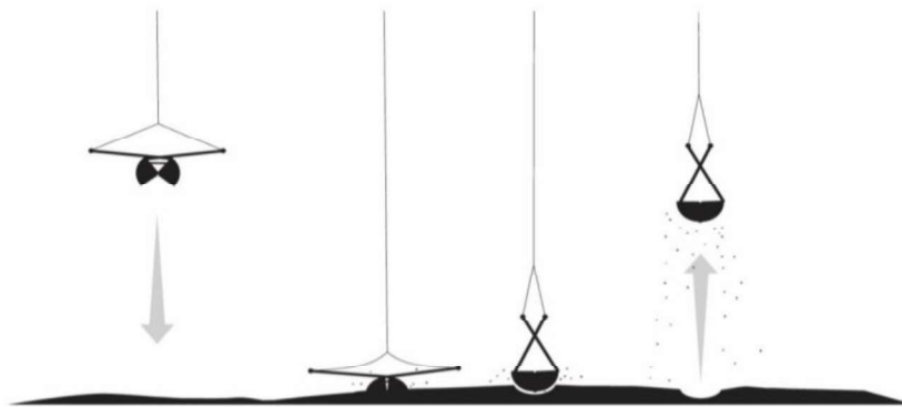
Figura 8. Da esquerda para a direita o modo de operação da draga Van Veen: lançamento, chegada ao fundo, fecho e recolha do sedimento (Gravura: Frederico Oliveira CCMAR/FBC).
