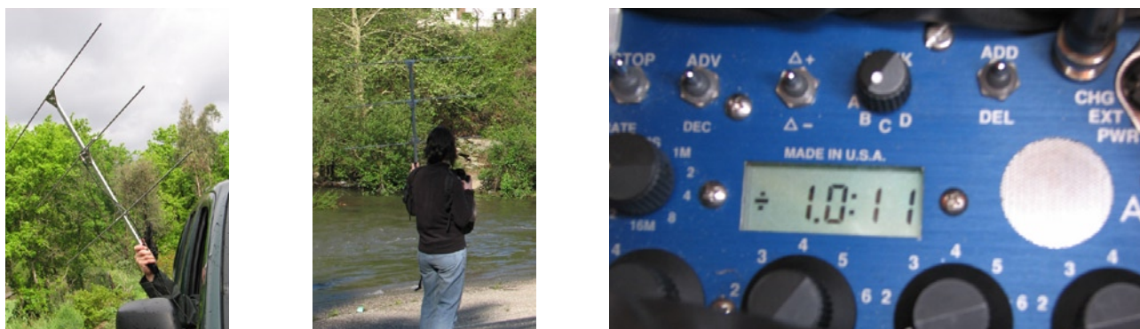
Figura 45 – Posicionamento, utilizando um receptor rádio com antena externa, dos indivíduos portadores de emissores.
