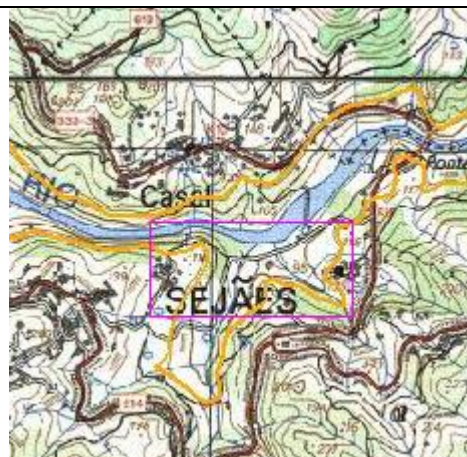
Extracto da Carta Topográfica, escala 1:25 000, folhas 165 e 176, com sobreposição do limite da albufeira
