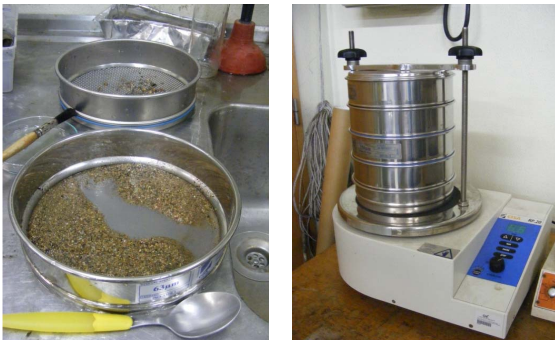
Figura 17. Crivos e agitador utilizados na determinação da composição granulométrica do sedimento.
