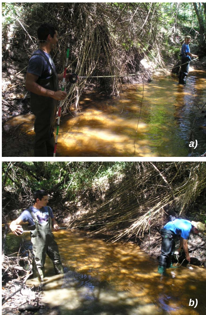
Figura 12. Pormenores da caracterização efectuada nos troços amostrados na Fase II: a) medição da distância entre transeptos e b) registo de variáveis (a fotografia exemplifica a medição da velocidade de corrente) num dos transeptos definidos.
