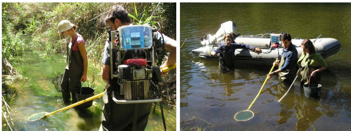
Figura 9. Aparelho de pesca eléctrica utilizado na captura de lampreias.
