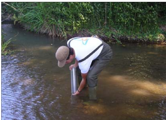
Figura 10. Recolha de amostra de sedimento com corer para análise granulométrica.
