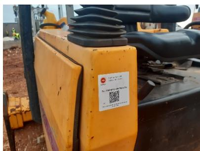
Implementação de QR code nas máquinas e outros equipamentos disponíveis nas obras de mais risco/complexidade, para acesso rápido à documentação dos mesmos. Adicionalmente, através do sistema implementado torna-se mais fácil verificar através de um telemóvel ou tablet utilizando uma APP do GEDOC quais as máquinas/equipamentos que estão conformes e quais aquelas que não poderão ser usadas na obra, e que requerem intervenção imediata.
