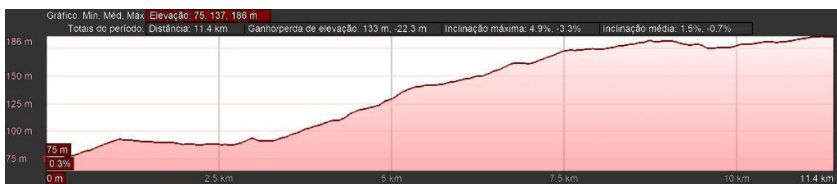
Figura 23 – Primeiro perfil de elevação no sentido norte-sul do Complexo Eólico Catanduba RN englobando a AII, AID e ADA, dos Parques Eólicos Catanduba RN I e II, numa distância de cerca de 11,4km denota-se que o relevo é plano a ondulado, assim como apresenta baixas declividades e partindo de altitudes de cerca de 80m de elevação à 190 m de elevação.
