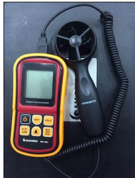
Foto 31 – Anemômetro portátil utilizado no monitoramento de ruídos. Fonte: CSA.
