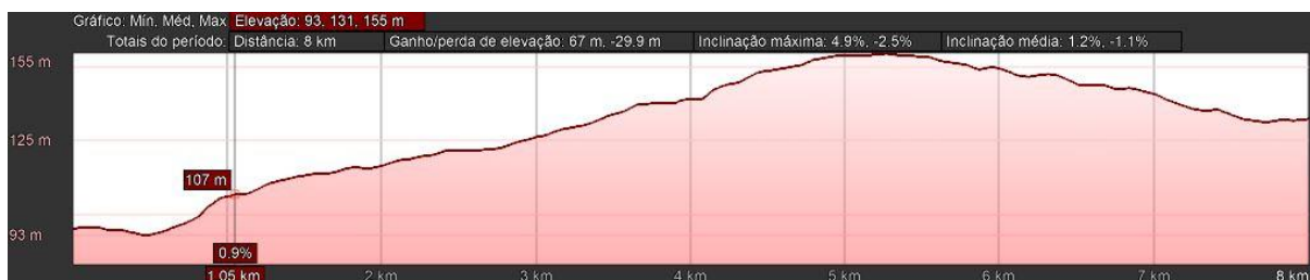
Figura 24 – Segundo perfil de elevação no sentido oeste-leste do Complexo Eólico Catanduba RN e que engloba as suas ADA, AID e AII. Assim como o perfil anterior, é observado um relevo plano a ondulado, com altitudes variando de 90 metros de elevação à 155m e possuindo baixas declividades.
