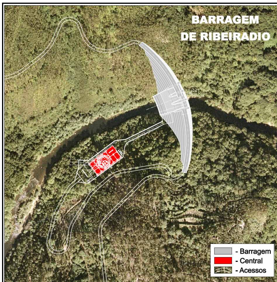
Figura 9 - Novo acesso norte/sul pela barragem de Ribeiradio
