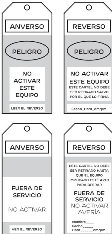
Figura 1. Ejemplos de carteles que pueden colocarse sobre los dispositivos de maniobra para que no sean accionados.
