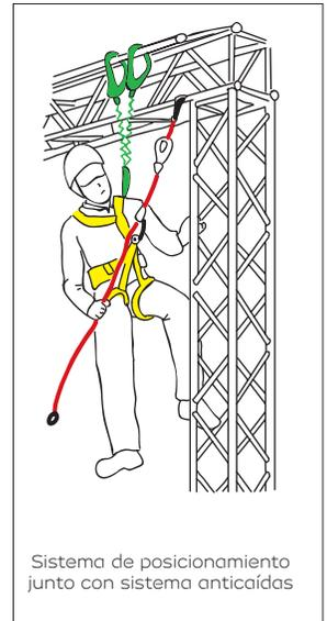
Sistema de posicionamiento junto con sistema anticaídas
