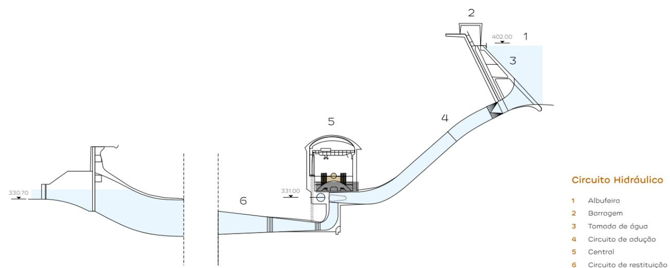
Na central I estão instalados três grupos geradores, equipados com turbinas Francis de eixo vertical e alternadores trifásicos, com potências nominais unitárias de 80 MW e 78 MVA, respetivamente. A central II possui apenas um grupo, equipado com uma turbina Francis e com um alternador, com potências nominais de 191 MW e 212 MVA, respetivamente.
