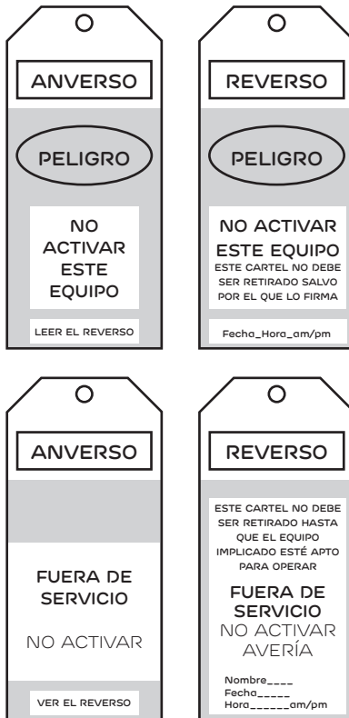
Figura 1. Ejemplos de carteles que pueden colocarse sobre los dispositivos de maniobra para que no sean accionados.
