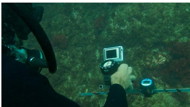
Investigador observa através de um monitor LCD as imagens que o vídeo regista. Uma bússola montada no topo do dispositivo permite a navegação subaquática.
