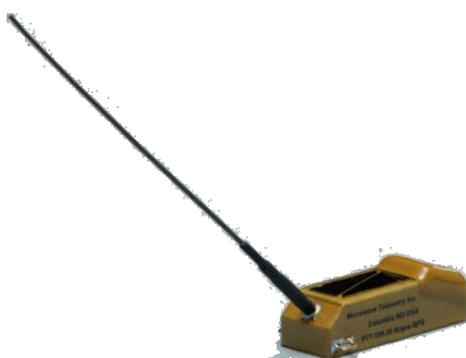
Figura 3 – Imagem de um PTT Solar ARGOS/GPS de 30 gr, semelhante aos utilizados neste estudo para seguir os movimentos dos sisões.
